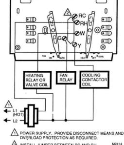
INSTALL JUMPER BETWEEN RC AND RH.
